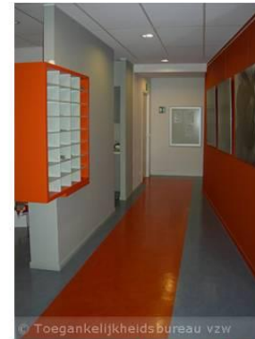
Zorg voor een logische structuur van de route (gangen). Het gebruik van kleurcontrasten, verschillende materialen... draagt steeds bij tot een intuïtief gebruik (bijvoorbeeld een gekleurde strook op de vloer geeft de looprichting aan)
